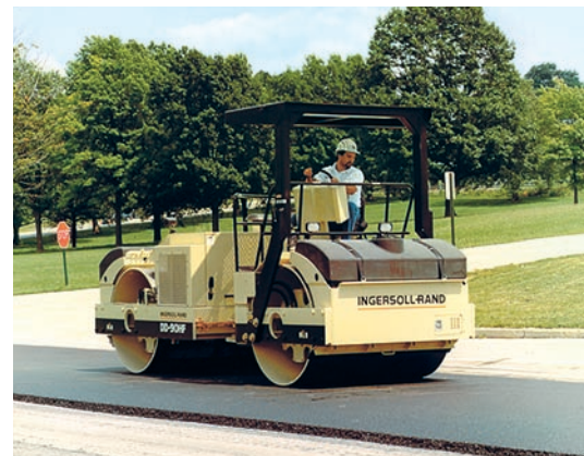
振动压路机的激振轴可以被新的 INA/FAG 圆柱滚子轴承可靠支撑（图片：Ingersoll-Rand）
