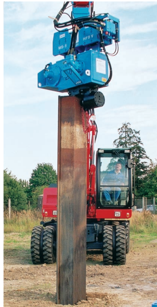
动态特性要求：LSL 系列圆柱滚子轴承可以承受高加速度——非常重要，例如用于振动打桩机（图片：ThyssenKrupp）
