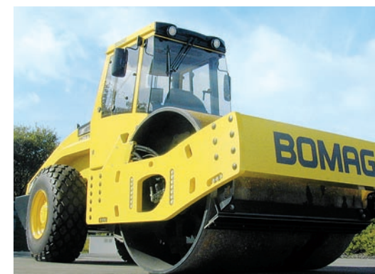
在铰接/回转接头中采用四点接触式球轴承和免维护 ELGES 关节轴承的振动压路机 (图片: BOMAG)
